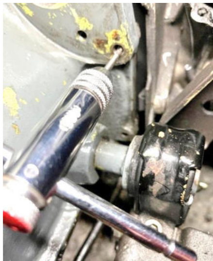
Foto 2: Gewinde M4 schneiden
