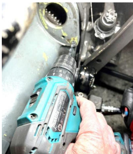
Foto 3: Aufbohren auf 6 mm
